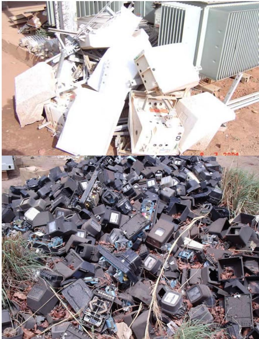
Equipements électriques en fin de vie, contenant des PCB, déposés sans mesure de protection dans l'environnement et pouvant menacer la santé humaine
