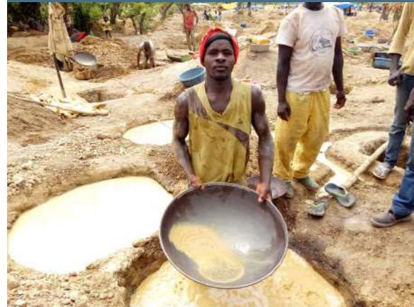
Photo 2 : Concentration d'or à la batée près de Dossi, région des Hauts-Bassins - mai 2018
