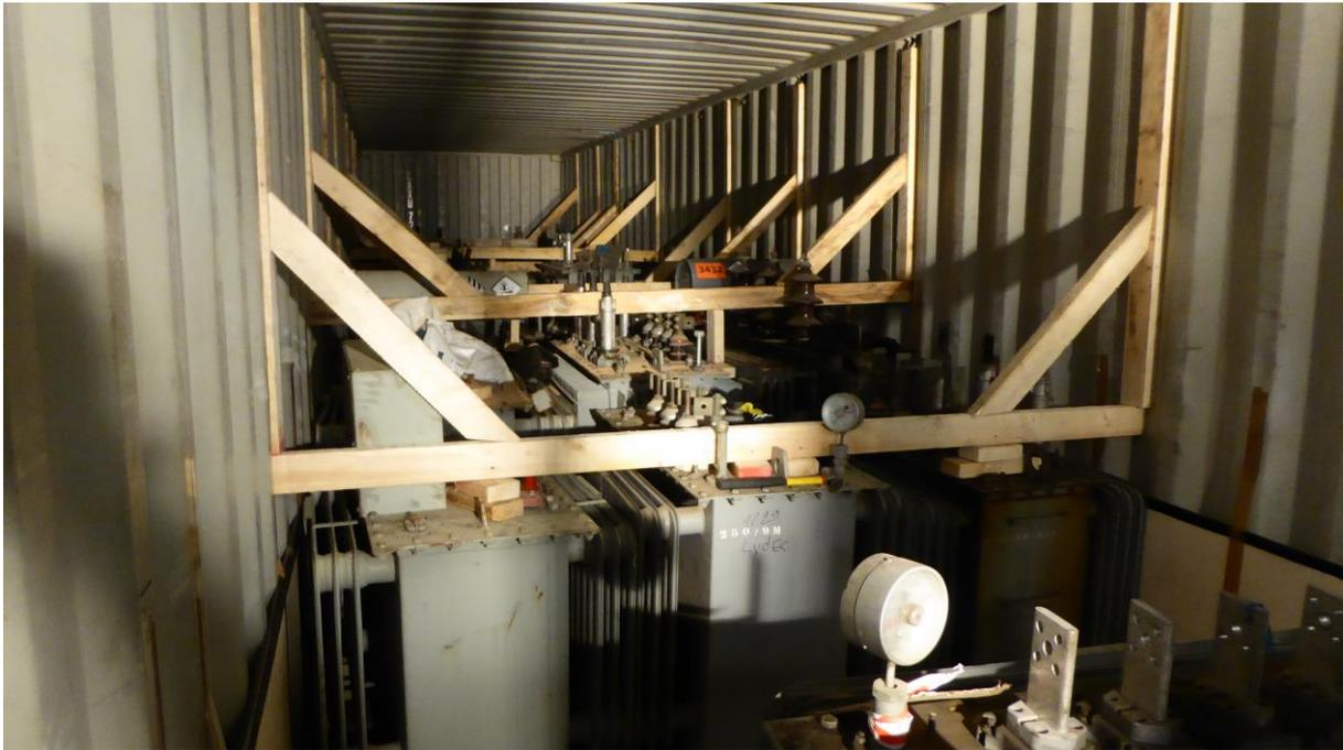
**Fig. : Transformateurs vides, stabilisés et bien callés dans le conteneur pour transport transfrontalier.**
