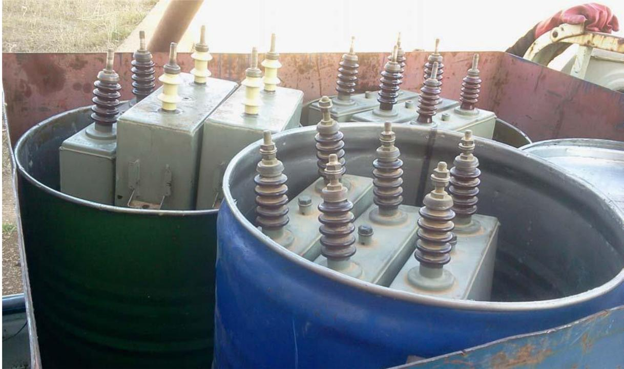
Fig. : Conditionnement des condensateurs dans des fûts homologués ONU.
